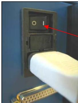
Gerät mit dem Netzschalter einschalten.
